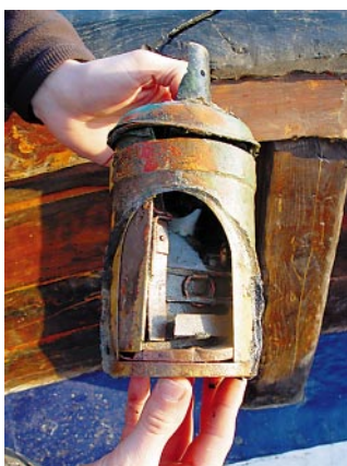
Fot. 4. Lampa naftowa do oświetlenia żyrokompasu, wydobyta z wraku „Christiny”
