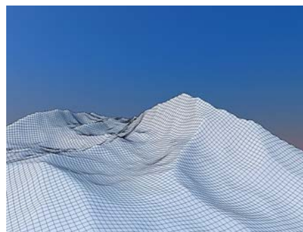
Ryc. 3. Siatka cyfrowego modelu terenu złożona z około 62000 poligonów (archiwum autora) Fig. 3. A mesh of a digital model of an area consisting of about 62000 polygons (author's archive)
