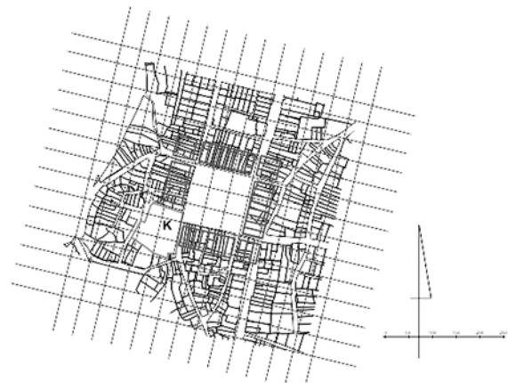
Ryc. 7. Słomniki. Rekonstrukcja układu lokacyjnych działek siedliskowych o wymiarach 50 × 150 stóp na tle siatki sznurowej. Opracowanie autora na bazie cyfrowego planu ewidencji gruntów. Legenda: K – działka kościelna
