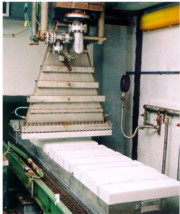
Ryc. 7. Skaner przemiata wiązkę elektronów na szerokość skrzynki. Na transporterze poruszają się w skrzynkach przedmioty poddawane radiacyjnej sterylizacji
