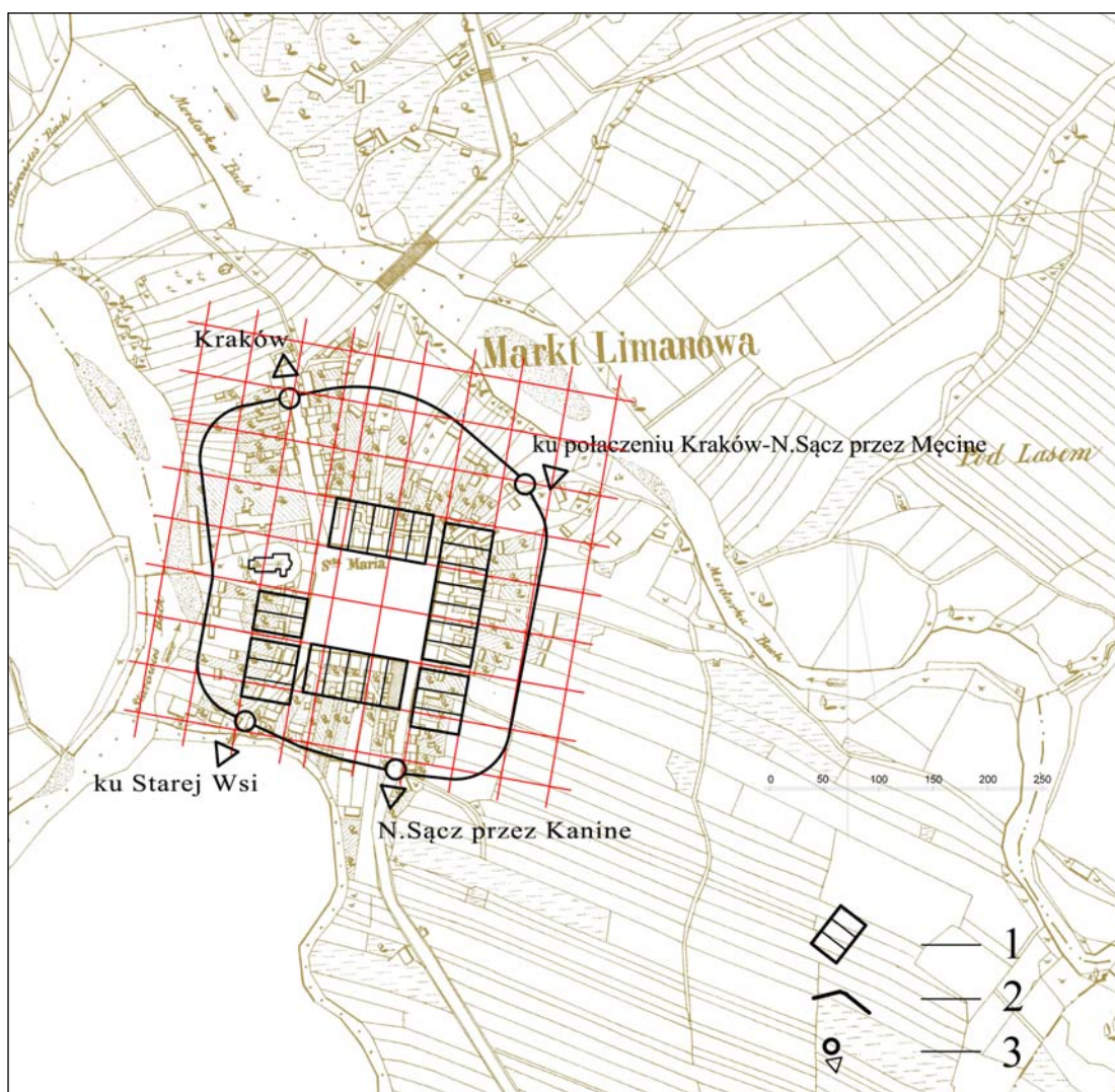
Ryc. 9. Limanowa. Próba rekonstrukcji zasad rozplanowania układu lokacyjnego miasta w oparciu o wielkość działki siedliskowej na tle modularnej siatki mierniczej o wielkości 1 sznura liczonego stopą o długości 0,3 metra. Opracowanie autora na bazie planu katastralnego Limanowej pochodzącego z 1845 roku
